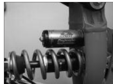
Rearshocks in Position «vorne-oben»
