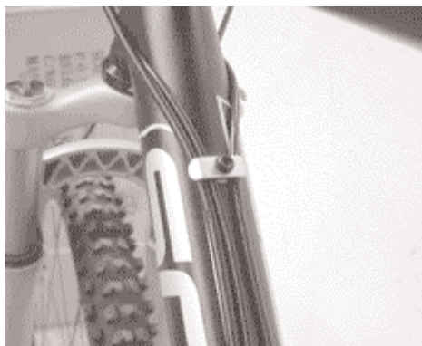
PERCURSO INTELIGENTE DOS CABOS
