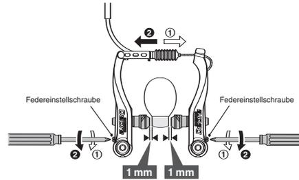
4. Ziehen Sie den Bremshebel ungefähr 10 Mal bis zum Griff an und kontrollieren Sie die richtige Funktion und den Bremsschuhabstand, bevor Sie die Bremsen verwenden.
