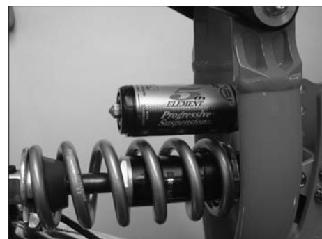
Amortiguador en posición « front - top »
