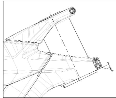
4. ziehen Sie die 3 Schrauben mit einem Drehmoment von 5Nm/44in-lbs an
