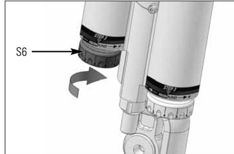
Mit Hilfe der roten Schrauben (S6 & S7) auf der Unterseite der Luftkammern können Sie den Rebound schrittweise verstellen.
