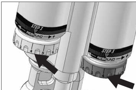
Als Rebound bezeichnet man die Ausfederungsgeschwindigkeit des Dämpfers und somit des Hinterbaus, nach dem Überfahren eines Hindernisses zurück in seine Ausgangslage.
