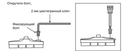
Удалите тормозную колодку из его крепления (по направлению стрелки)
