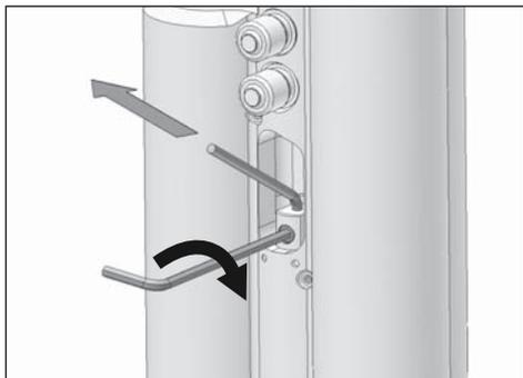
6. Натяните трос и затяните его винтом крепления троса (S10), используя шестигранный ключ 2 мм.
