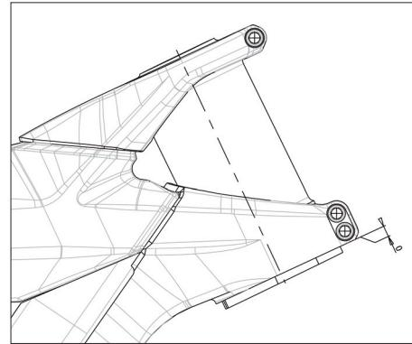
4. ziehen Sie die 3 Schrauben mit einem Drehmoment von 5Nm/44in-lbs an
