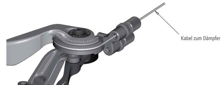
Bitte beachten Sie, dass das Kabel für den Dämpfer IMMER das obere Kabel am Fernbedienungshebel ist, wie untenstehend abgebildet. Es gibt 3 verschiedene Versionen für die verschiedenen Dämpfermodelle. Bitte überprüfen Sie, dass der Hebel zum jeweiligen Dämpfer passt.
