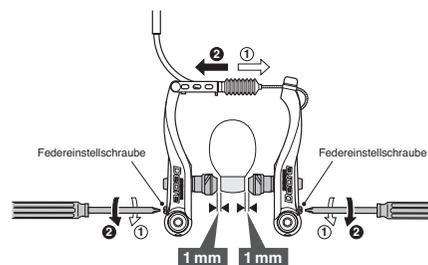
4. Ziehen Sie den Bremshebel ungefähr 10 Mal bis zum Griff an und kontrollieren sie die richtige Funktion und den Bremschuhabstand, bevor Sie die Bremsen verwenden.
