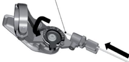
con una vite da 2mm con un serraggio di 0,9Nm/8lb/n.
