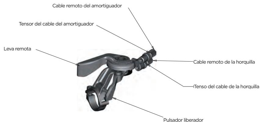
Téngase en cuenta que el cable de que controla el amortiguador SIEMPRE está en la posición superior tal y como se ve en la imagen inferior.
