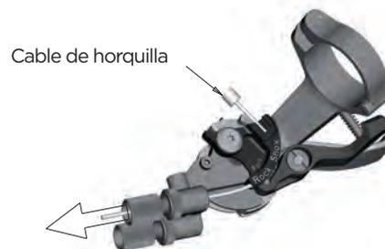
Fijar el tornillo allen de 2mm de la roldana de bloqueo de la horquilla con un par de apriete de 0.9Nm, corte el cable y coloque un terminal.
