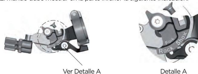
Para colocar el cable coloque el mando en la posición de Modo Descenso e introduzca el cable por el orificio como se ve en la imagen inferior, colocar el cable en el bloqueo de la horquilla situado en la parte derecha del puente de la misma.
