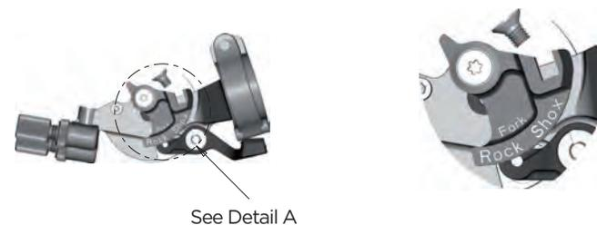
Per assemblare il filo posizionare la leva in Air travel; premere il filo nell' ugello come mostrato di seguito e fissarlo alla corona della forcella.
