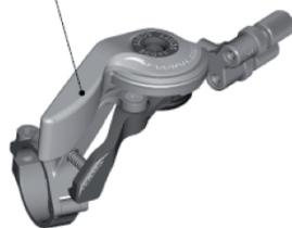
premere il filo nell' ugello come mostrato di seguito e fissarlo alla corona della forcella con una vite da 2mm con un serraggio di 0,9Nm/8lb/n.
