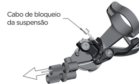
Aperte o cabo no sistema de bloqueio da suspensão com uma chave sextavada de 2mm com um torque de aperto de 0,9 Nm, corte o cabo e aplique um terminal. Pode também verificar estes passos no manual Sram/Rock Shock que acompanha a bicicleta.
