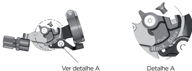
Para instalar o cabo coloque o manípulo na posição de curso total, insira o cabo na ranhura conforme demonstrado na gravura abaixo, com a cabeça do cabo no apoio e aperte o cabo no mecanismo de bloqueio no topo da perna esquerda da suspensão.
