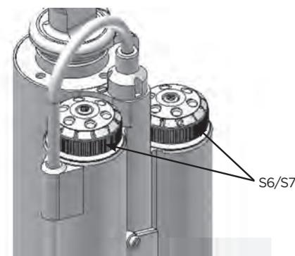
Usando os botões de ajuste (S6 e S7) na parte superior do amortecedor pode ajustar o Rebound, passo a passo
