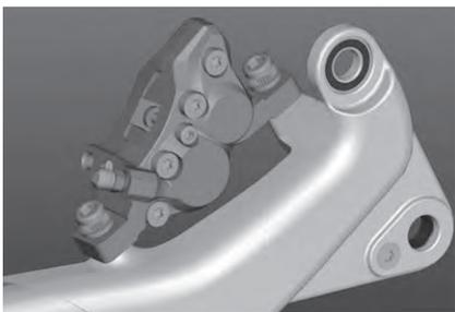
Caso pretenda aplicar um rotor de 203mm, deve utilizar o adaptador de travão específico do fabricante do travão que utiliza.
