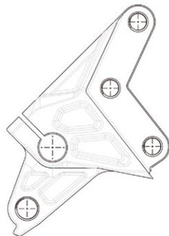
Otra opción es la puntera para eje SRAM-Maxle para bujes con eje 12mm/150mm through axle hubs
