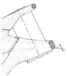
4. Aperte os três parafusos com um torque de 5Nm/44in-lbs
