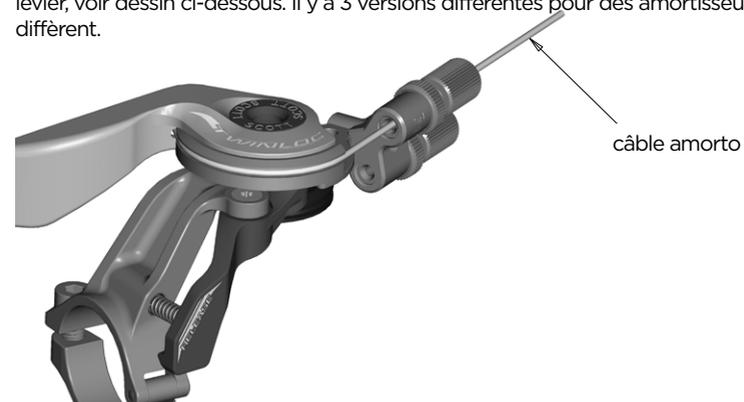
Pour l'assemblage du levier pour le lockout de la fourche il existe 2 systèmes de câble. Les différentes poulies pour le câble de la fourche peuvent être remplacé en quelques minutes pour adapter le levier à votre marque de fourche.
