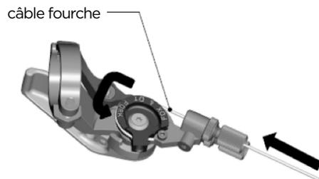
et assurez le câble en le serrant avec une clé six pans 2 mm, couple de serrage 0.9 Nm/ 8 lb/in, selon image ci-dessous.
