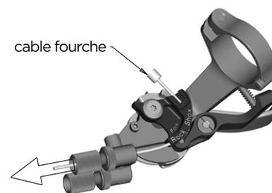
Fixez le câble avec la clé six pans 2 mm sur la pièce de fixation située sur le te de fourche avec un couple de serrage de 0.9Nm/ 8 lb/in, coupez le câble et mettez un capuchon de câble. Veuillez aussi consulter le manuel SRAM/RockShox livré avec votre VTT.
