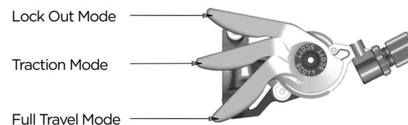
Changez le mode en poussant le levier avec vos doigts en avant et revenez en arrière en cliquant le bouton release (un mode par poussée)
