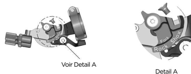
Pour assembler le câble, mettez le levier en position All Travel Mode, poussez le câble dans le passage selon dessin ci dessous, mettez le dans gaine pré coupée et fixer le sur le haut de la partie droite de la fourche
