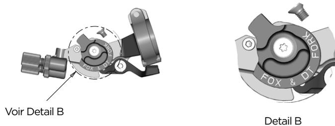
Pour assembler le câble, mettez le levier en position en Full Mode
