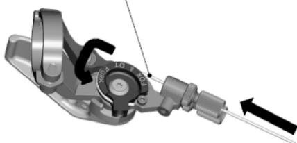
Fixe o cabo através do parafuso Allen de 2mm com um torque máximo de 0.9Nm tal como mostrado na Imagem seguinte
