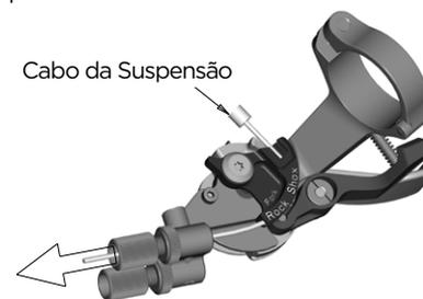
Fixe o cabo com uma chave Allen de 2mm no afinador da suspensão com um torque máximo de 0.9Nm, corte o cabo à medida e coloque por fim um terminal de cabo.
