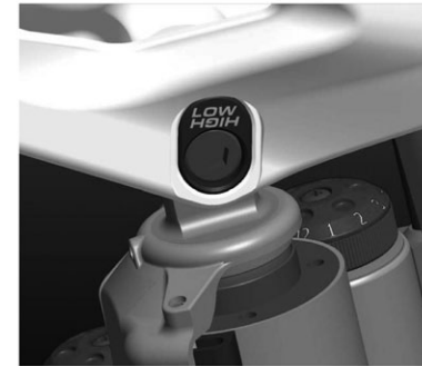
LOW Setting, niedriges Tretlager
