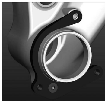
Usar tornillo 1x15mm. El hueco superior esta asegurado por el tornillo del guiacadenas. No usar con guiacadenas con cubreplato montado en el sistema ISCG.
