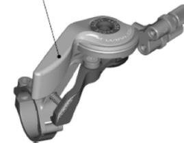
Schieben Sie das Fernbedienungskabel durch die bereits passend abgelängte Kabelhülle in den Hebel, wie in der nächsten Abbildung gezeigt:
