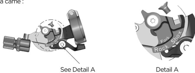
Placez le levier en position All-Travel afin de monter le câble. Insérez le câble dans l'orifice comme indiqué ci-dessous, insérez-le dans la gaine préalablement adaptée et fixez-le sur le Lock-out sur la partie supérieure droite du Té de la fourche.
