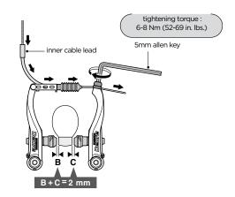
3. Regolate la distanza tramite la vite di regolazione della tensione
