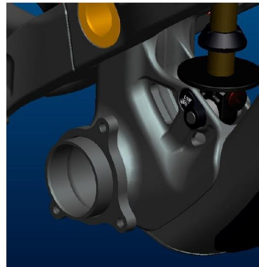
1. BB PF 104 mit einer Gehäusebreite von 104mm und einem Innendurchmesser von 41mm für PressFit Kugellager.
