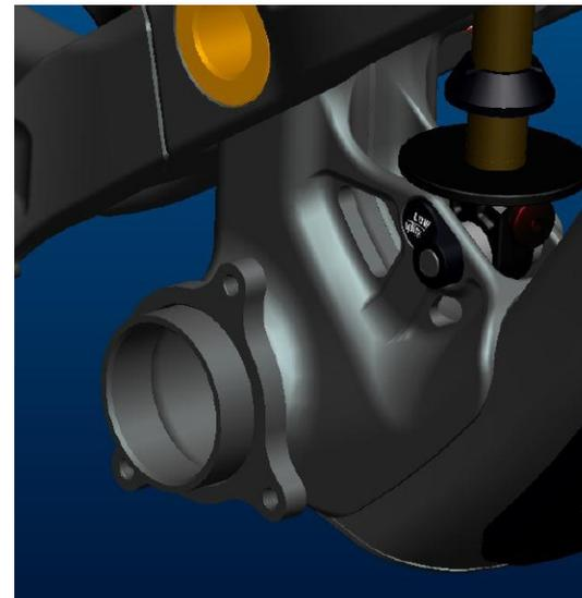
1. BB PF 104 com uma caixa de bloco pedaleiro de 104mm e um diâmetro interno de 41 preparado para caixas “press fit”.
