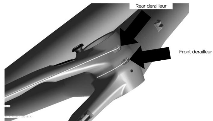
4. Poussez les câbles pour les trous prévus à cet effet et clipsez le guide-cable dans le boîtier.
