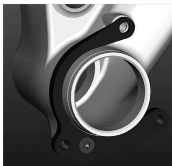
Benutzen Sie 1 x 15mm lange Schraube. Die obere Befestigung wird durch die Schraube der Kettenführungsplatte fixiert. Nicht für die Benutzung von Kettenführungen mit „Bashplate“ an der ISCG Halterung!
