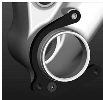
Utilize um parafuso de 15mm de comprimento. O furo de cima destina-se ao aperto do parafuso da guia de corrente.
