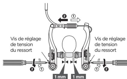
4. Actionner les leviers de frein une dizaine de fois jusqu'à la poignée et contrôler tous les éléments du système de freinage.
