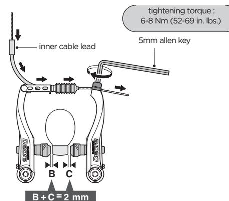
3. Regolate la distanza tramite la vite di regolazione della tensione
