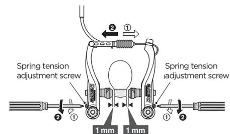
4. Aperte a manete do travão umas 10 vezes até ao punho e verifique se tudo funciona correctamente e assegure-se de que os calços continuam com a mesma folga depois de activar o travão
