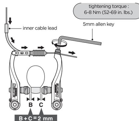
3. Ajuste o balanço com os parafusos de afinação da tensão das molas.
