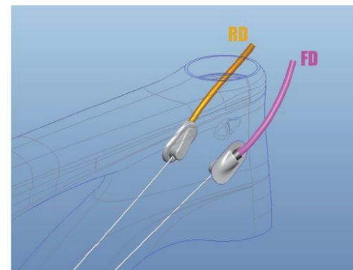
Soyez attentif au fait que les câbles doivent se croiser à l'intérieur du cadre avant de sortir sous le tube inférieur.
