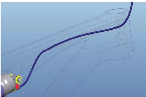
Sur les cadres aluminium du Genius, le passage du câble se fait à l'extérieur du cadre. La gaine est fixée sur les guides câbles à l'aide de fixations plastique et /ou de colliers.
