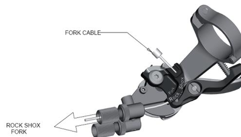
2. Fixez le câble avec une clé Inbus 2 mm sur le mécanisme de réglage du Lock-out, sur la partie supérieure droite du Tê de la fourche, au couple 0.9Nm/8lb/in. Raccourcissez le câble et assurez-le avec un embout de câble. Référez-vous également au manuel de SRAM / ROCK SHOX joint au bike/à la fourche.
