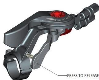
Il existe 2 systèmes de cames différents pour le levier de la fourche. Les différentes cames pour le passage de câble du levier de la fourche peuvent être changées en quelques minutes pour adapter la course du câble au type de fourche.
