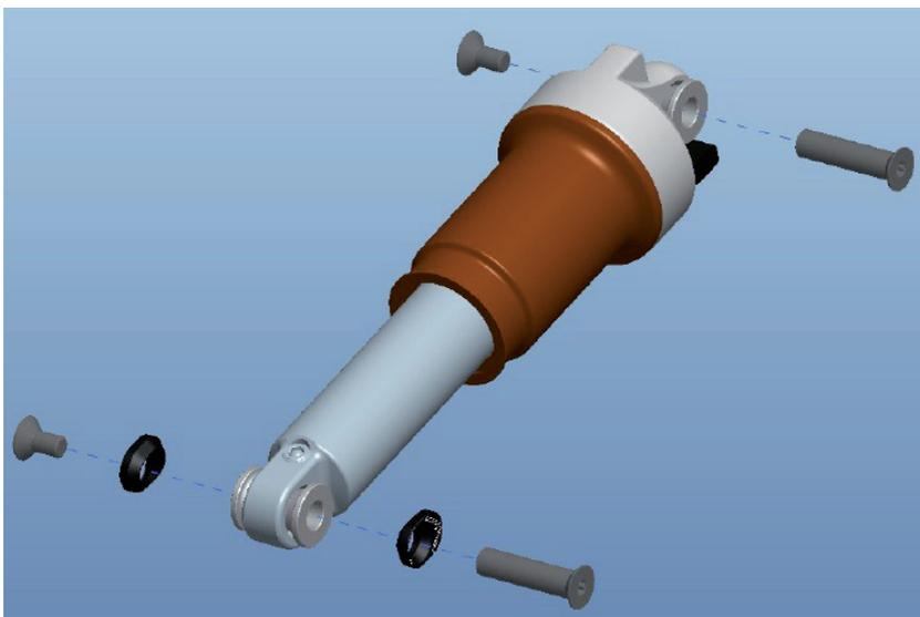
N'utilisez que les adaptateurs qui sont adaptés aux vis à tête conique de l'amortisseur.
