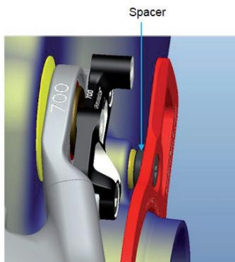
Détails du montage sur les cadres en aluminium du Genius:
