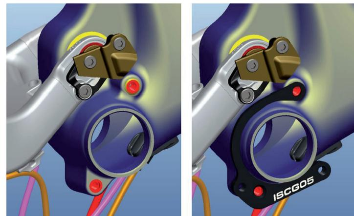
En cas de montage d'un guide chaîne, l'adaptateur doit être monté sur les points de fixation ISCG 05.
