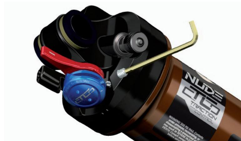
2. Insérez un nouveau câble dans l'orifice prévu à cet effet dans le levier, dans la gaine, puis dans la molette de changement de mode de l'amortisseur (S6), comme illustré:
