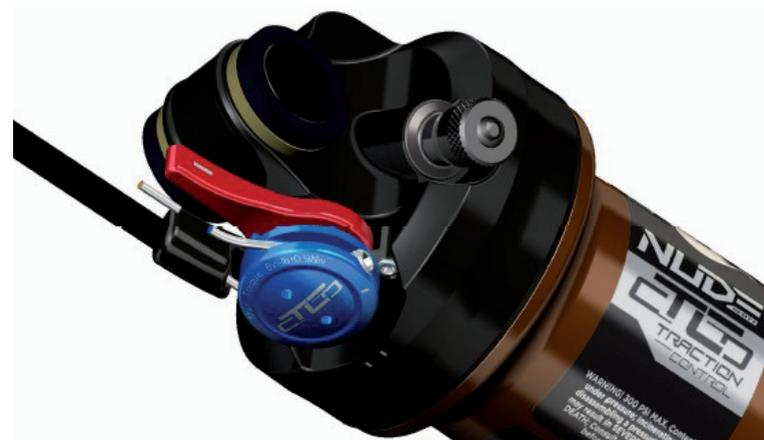
4. Positionnez le levier en mode Traction. La marque sur la came de l'amortisseur doit être positionnée comme illustré ci-dessous :
