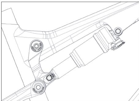
**Les axes de l'amortisseur devraient, après démontage, être resserrés au couple 5Nm/44in lbs.**
