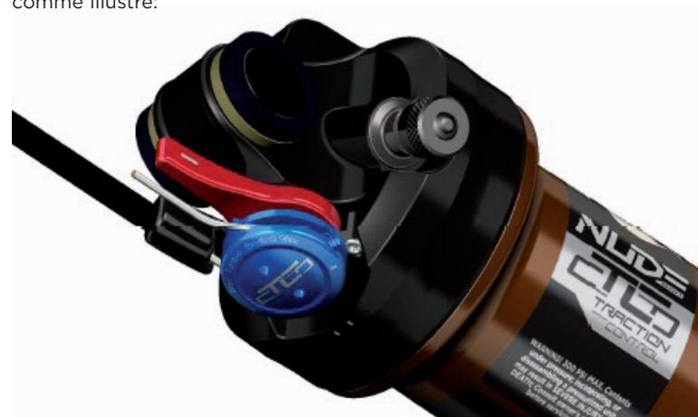
3. Tendez le câble et fixez-le en vissant la vis de fixation (S7), en tournant dans le sens des aiguilles d'une montre, à l'aide d'une clé Inbus 2 mm, au couple maximum de 1,6 Nm.
