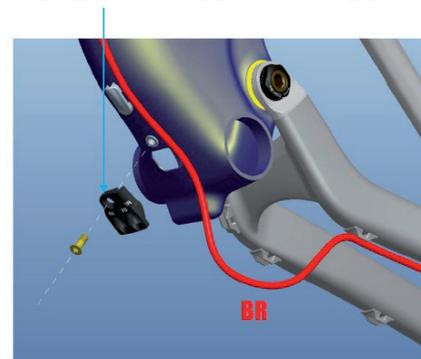
Fixez la durite et le câble du levier de la tige de selle télescopique (le cas échéant) sur le cadre en utilisant la fixation illustrée ci-après :
