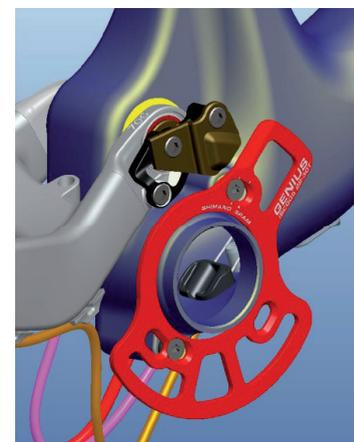
Le guide chaîne doit être monté exactement comme illustré en utilisation toutes les pièces du set.
