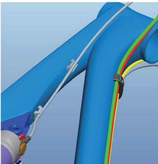
1. Desserrez la vis de fixation du câble (S7) en tournant dans le sens contraire des aiguilles d'une montre à l'aide d'une clé Inbus de 2mm:
