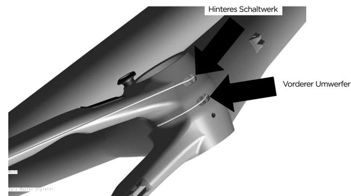
4. Schieben Sie sie durch die hierfür vorgesehenen Löcher in der Kabelführung und klipsen Sie die Kabelführung in das Tretlagergehäuse.
