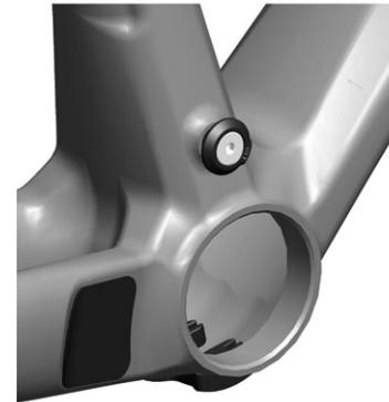
Die Klammer des vorderen Umwerfers hat einen Innendurchmesser von 38.2mm, die Kabelführung des Rahmens ist vorgesehen für "down route/pull - down swing" Modelle.
