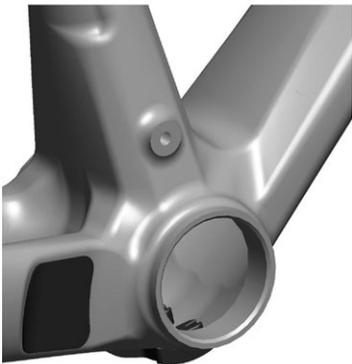
Die Klammer des vorderen Umwerfers hat einen Innendurchmesser von 34.9mm, die Kabelführung des Rahmens ist vorgesehen für "down route/pull - down swing" Modelle.
