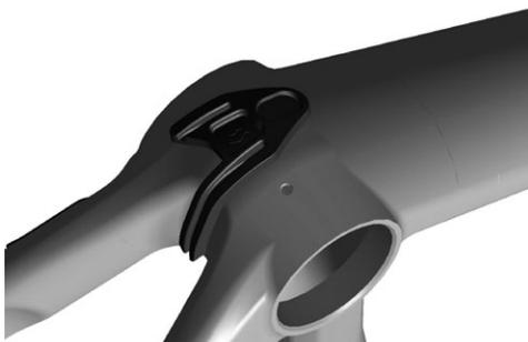
Bitte beachten Sie, dass die äusseren Kabelhüllen für FD und RD nur bis zu den Kabelstoppfern am Kabeleingang am vorderen Ende des Unterrohres gehen.
