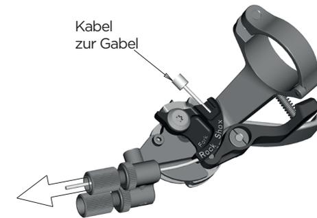
Befestigen Sie das Kabel mit einem 2 mm Inbusschlüssel am Verstellmechanismus des Lock-out auf der Oberseite der rechten Seite der Gabelkrone mit einem Drehmoment von 0.9Nm/8lb/in, kürzen Sie das Kabel und sichern Sie es mit einer r Kabelendhülle. Bitte beachten Sie hierzu auch die dem Bike/der Gabel beiliegende Bedienungsanleitung von SRAM/RockShox oder FOX.
