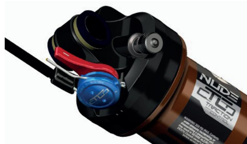
3. Straffen Sie das Kabel und drehen Sie die Kabelbefestigungsschraube (S7) im Uhrzeigersinn mit einem 2mm Inbusschlüssel mit einem maximalen Drehmoment von 1,6Nm.
