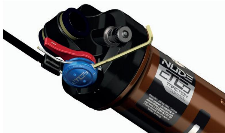
4. Bringen Sie den Fernbedienungshebel am Lenker in die Traction Mode Position. Nun sollte die Markierung der Kabelrolle am Dämpfer wie untenstehend abgebildet positioniert sein:
