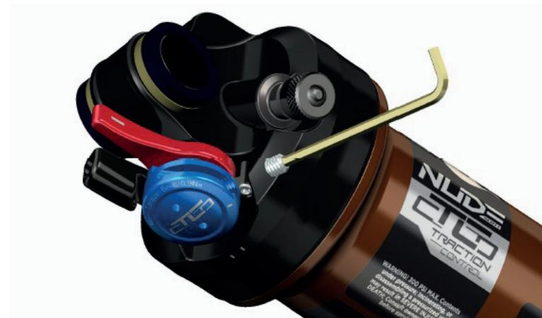
2. Inserte un nuevo cable a través del mando y la funda de cable, e introduzca en el amortiguador alrededor del dial remoto (S6)
