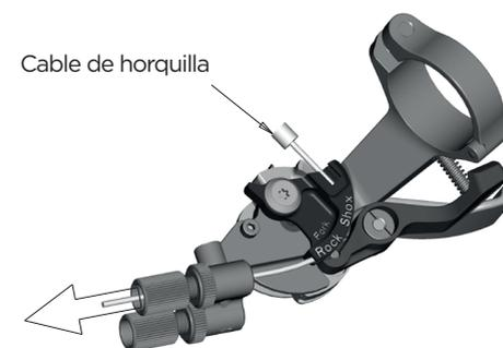
Fijar el tornillo allen de 2mm de la roldana de bloqueo de la horquilla con un par de apriete de 0.9Nm, corte el cable y coloque un terminal.
