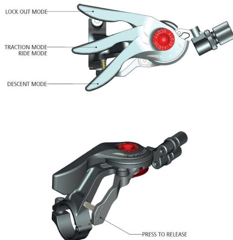
Para a montagem do controlo remoto da suspensão dianteira, existem três sistemas diferentes.
