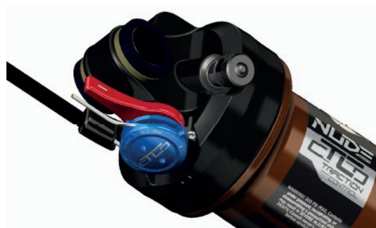
3. Aperte o cabo e aperte o parafuso de fixação do cabo (S7), apertando-o no sentido dos ponteiros do relógio com uma chave sextavada de 2mm. A força de aperto não deve exceder 1.6Nm.
