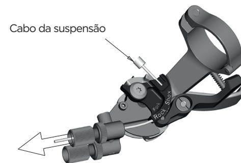
Fixe o cabo utilizando o parafuso sextavado de 2mm no botão rotativo de bloqueio da suspensão com uma força de aperto de 0.9Nm/ 8lb/in, corte o excedente de cabo e instale um terminal de cabo. Para aprender mais informação relativa a esta tarefa, pode visualizar o manual da sua suspensão SRAM/RockShox, fornecido com a documentação da sua bicicleta ou contacte um centro de serviço ou o seu Agente.
