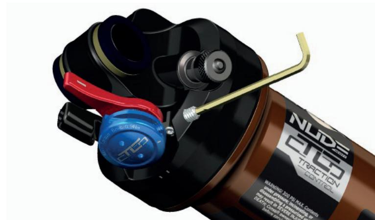
2. Insira um novo cabo através do furo no manípulo e bicha e introduza-o no amortecedor conforme a ilustração, à volta da roda de controlo remoto (S6).
