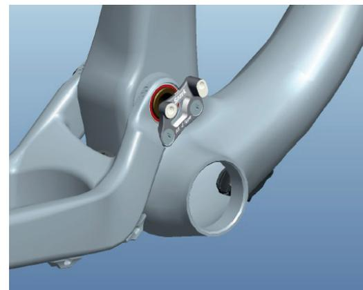
Todos os quadros com triângulos dianteiros em alumínio utilizam blocos pedaleiros roscados com 73mm de largura.
