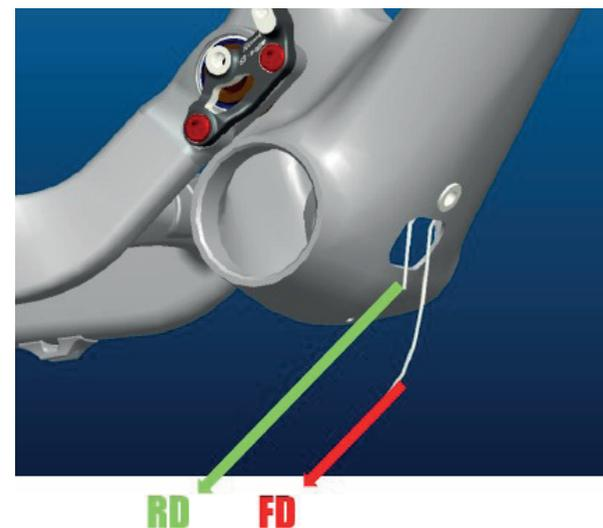
Empurre os cabos através da guia conforme a ilustração e fixe a guia no quadro com uma chave sextavada de 3mm com uma força de aperto de 4Nm/35in/lbs.
