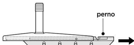
Passate il cavo interno attraverso la guida, dopodiché regolate la distanza totale tra il pattino destro e sinistro ed il cerchione fino a 2mm, stringendo il bullone di fissaggio del cavo. Fate scivolare i nuovi pattini dentro i supporti ed accertatevi che la direzione sia corretta, che il foro del perno di sicurezza corrisponda.
