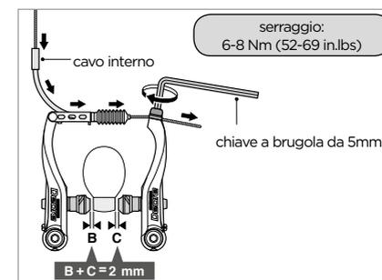
3. Regolate la distanza tramite la vite di regolazione della tensione
