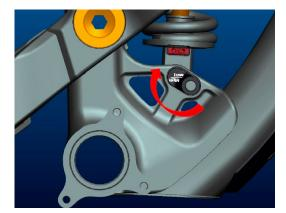
Um die Einstellung zu verändern, lösen Sie bitte, wie folgend dargestellt, den Dämpferbolzen mit einem 6mm Inbusschlüssel.
