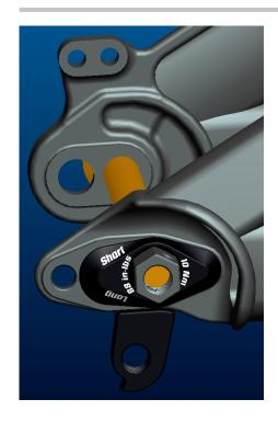
Natürlich bietet das Gambler 700 auch die Möglichkeit das Schaltwerkbefestigungsauge im Falle eines Schadens auszutauschen.
