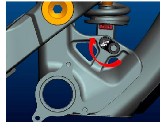
Afin de modifier la hauteur de boîtier, desserrez la vis basse d'amortisseur à l'aide d'une clef Allen de 6mm. Retournez l'entretoise de géométrie de chaque côté comme montré sur le dessin ci-dessous et resserrez la vis d'amortisseur à nouveau en respectant le couple maximum de 35Nm/308in/lbs.
