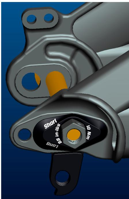
Le Gambler 700 offre la possibilité de changer la patte de dérailleur en cas de dommage de celle-ci, par ailleurs il est aussi possible de choisir entre 2 longueurs de bases en modifiant la position de l'axe de roue arrière dans le cadre.
