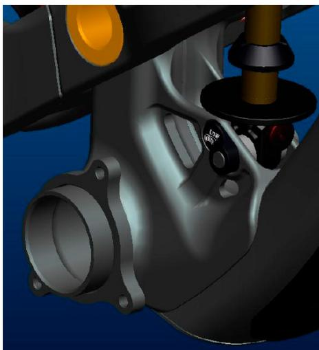
Sur le Gambler 700, le standard de boitier de pédalier est PF104 avec une largeur de 104 mm et compatible avec des cartouches de roulements pressfit de diamètre 41 mm.
