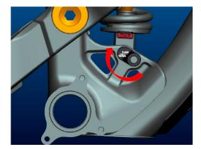
Para modificar a afinação de altura utilize uma chave sextavada interior de 6mm e desaperte o parafuso de suporte do amortecedor.
