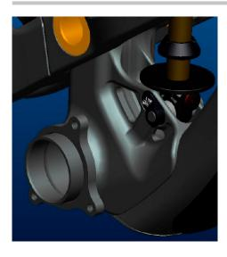
Na Gambler 700 encontrará uma medida de bloco pedaleiro de 104mm de largura por 41mm de diâmetro do tipo "PF 104" ou seja com rolamentos do tipo press fit.
