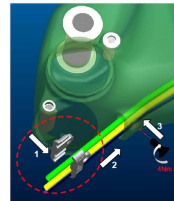
Ricordarsi di mantenere una distanza minima di 40mm tra la scatola del movimento centrale e il cavo per evitare spostamento e/o danneggiamento del cavo e del freno.
