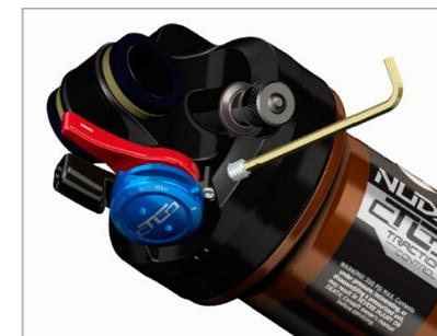
2. Inserire un nuovo cavo nel foro e spingerlo nell'ammortizzatore attorno alla rotella di fissaggio del cavo come mostrato nell'immagine.
