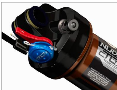
6. Spingere il cavo fino alla fine. Fissarlo premendo con delle pinze.
