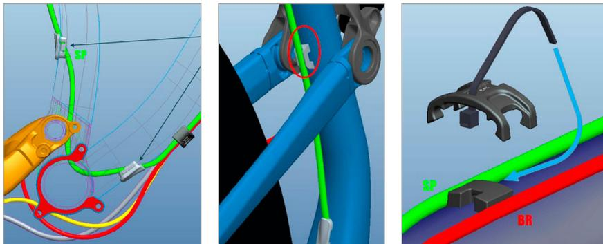
Oltre ai cavi del deragliatore e all'alloggio del freno è possibile, nei telai in carbonio, avere un passacavo integrato per il cavo del canotto sella.
