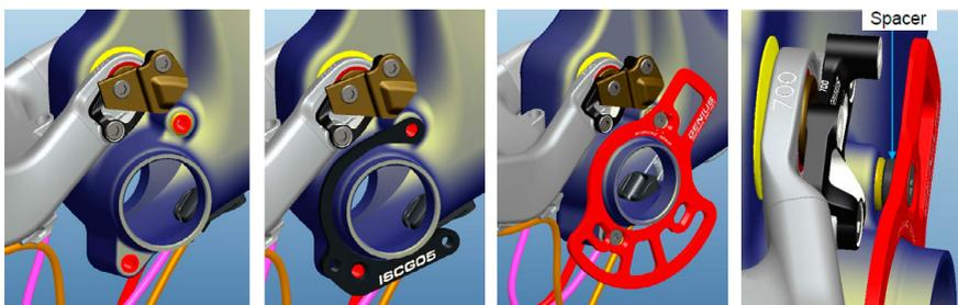
Attenzione perchè il chainblocker deve essere montato esattamente come mostrato di seguito utilizzando tutte le parti presenti nel set.
