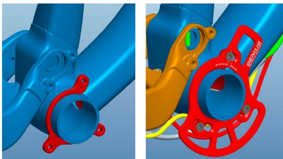
E' possibile assemblare il chainblocker direttamente sull' ISCG05 integrato.
