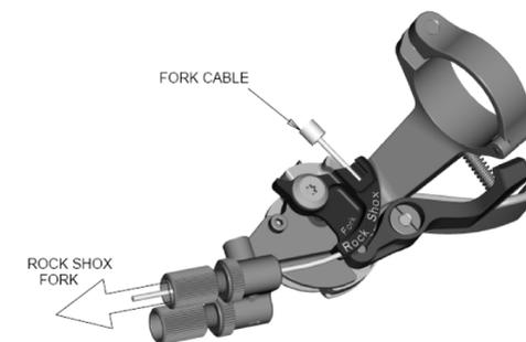
2. Fissare il cavo con una vite da 2mm con un serraggio di 0,9Nm/8lb/n; tagliare il cavo e assicurarlo con un tappo di chiusura.
