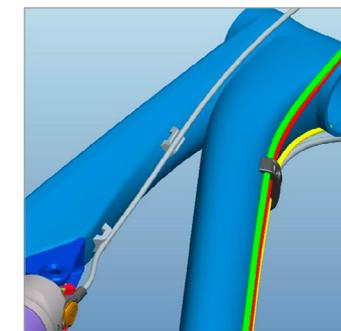
1. Allentare la vite di fissaggio del cavo (S7) ruotando in senso orario con una chiave a brugola da 2mm
