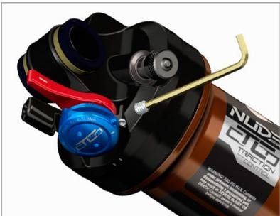
1. Lösen Sie die Kabelbefestigungsschraube (S7) durch drehen gegen den Uhrzeigersinn mit einem 2mm Inbusschlüssel
