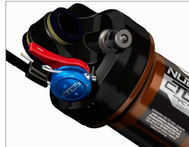
5. Kürzen Sie das Kabel ca. 20mm entfernt von der Fernbedienungsrolle
