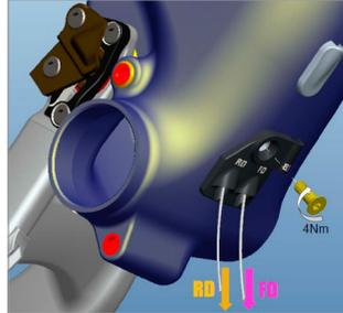
Schieben Sie nun die Kabelhüllen über die Kabel in die Kabelführung und beachten Sie hierbei die vorgegebene Mindestlänge der Hüllen wie unten abgebildet!
