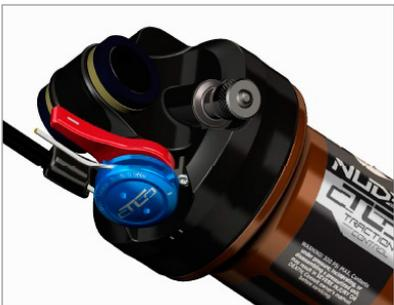
2. Schieben sie ein neues Kabel durch das dafür vorgesehene Loch im Fernbedienungshebel, die Kabelhülle und durch die Dämpferkabelführung um die Fernbedienungsumlenkrolle (S6), wie abgebildet
