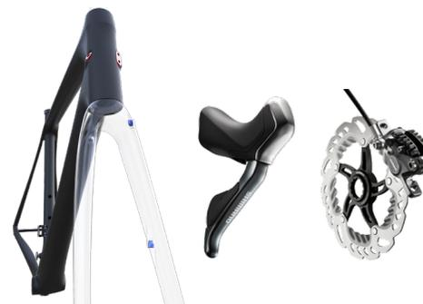
Tanto el cuadro como la horquilla Solace Disc utilizan sistema Post Mount de anclaje de freno, con discos de min: 140mm / max: 160mm
