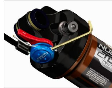
3. Straffen Sie das Kabel und drehen Sie die Kabelbefestigungsschraube (S7) im Uhrzeigersinn mit einem maximalen Drehmoment von 1,6Nm.
