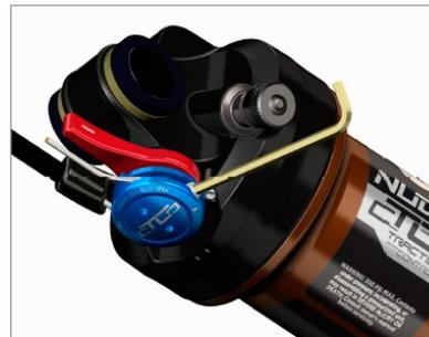
3. Stringere il cavo e fissare la vite (S7) girandola in senso orario con una chiave a brugola da 2mm con una torsione massima di 1.6Nm
