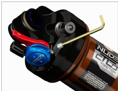
1. Liberte o cabo, desapertando o parafuso sextavado (S7) no sentido contrário aos ponteiros do relógio com uma chave de 2mm.
