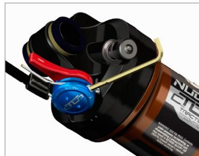
3. Aperte o cabo e aperte o parafuso de fixação do cabo (S7), apertando-o no sentido dos ponteiros do relógio com uma chave sextavada de 2mm. A força de aperto não deve exceder 1.6Nm.
