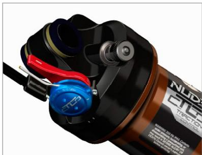
2. Insira um novo cabo através do furo no manípulo e bicha e introduza-o no amortecedor conforme a ilustração, à volta da roda de controlo remoto (S6).
