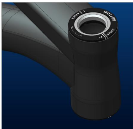
Sulla Voltage FR può essere utilizzata anche la serie sterzo Syncros Pressfit DH regolabile ( codice SCOTT 228442) per modificare la geometria ( angolo sterzo  $\pm 1^\circ$  o  $\pm 2^\circ$  ).
