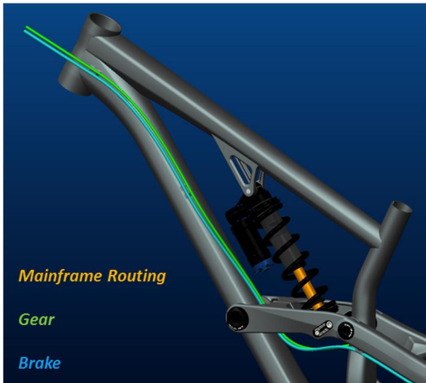
**Triângulo traseiro:** Passagem de cabos interna através da escora superior direita, sai da escora perto do drop out.
