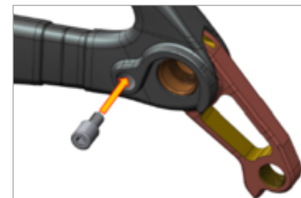
Introduzca el segundo tornillo en la parte interna de la puntera (torque máximo 1,5Nm)
