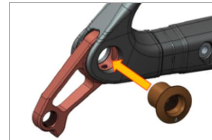
Inserire la boccola fra telaio e forcellino
