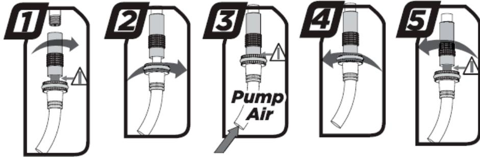
N.B. L'aria scorre nella manichetta e nell'indicatore quando si effettua la regolazione dell'aria e questo può dare l'impressione che l'ammortizzatore abbia meno pressione. Per questo è necessario regolarlo dopo aver effettuato questa operazione.
